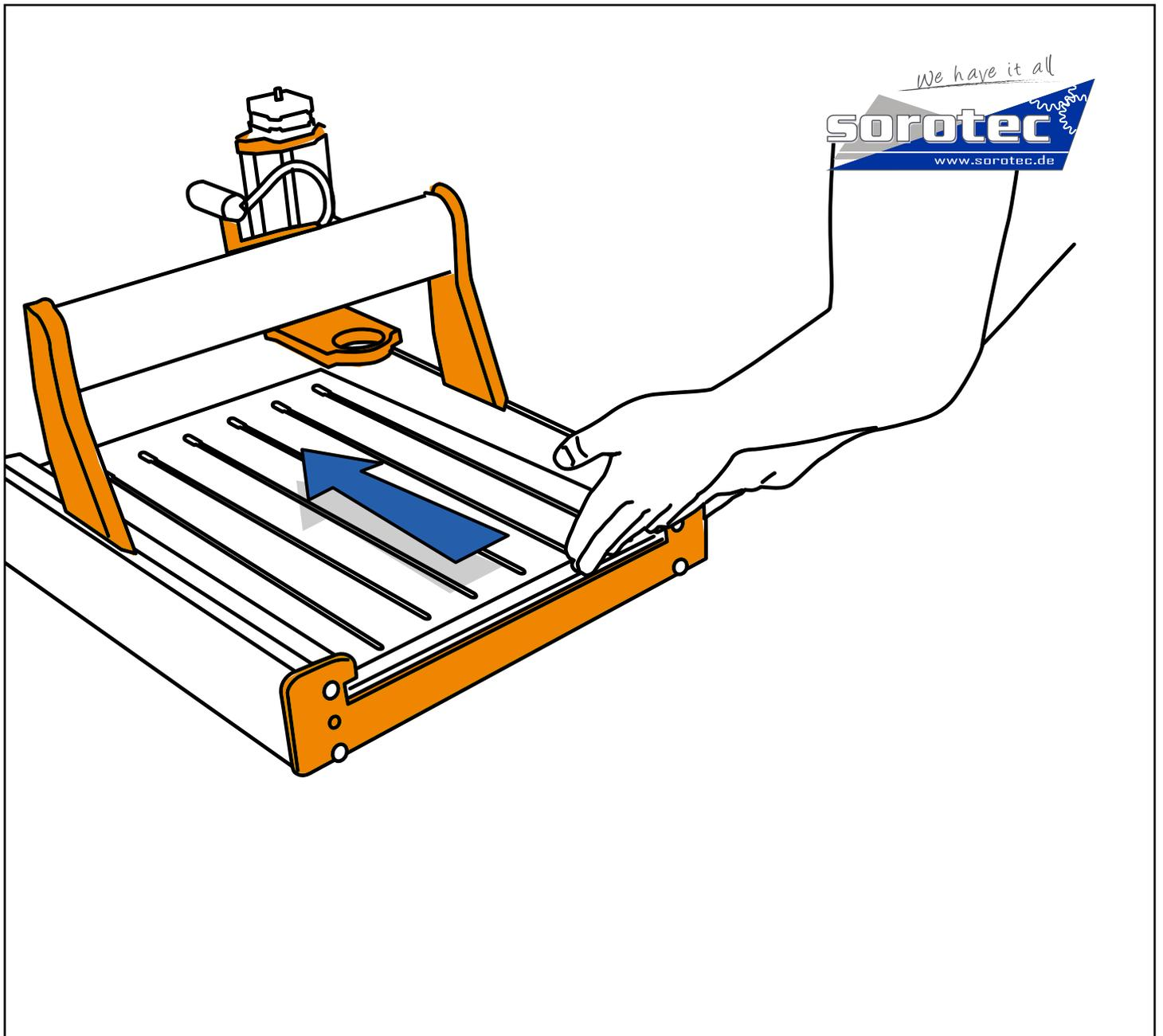
Nutenplatte bis zum Anschlag schieben
