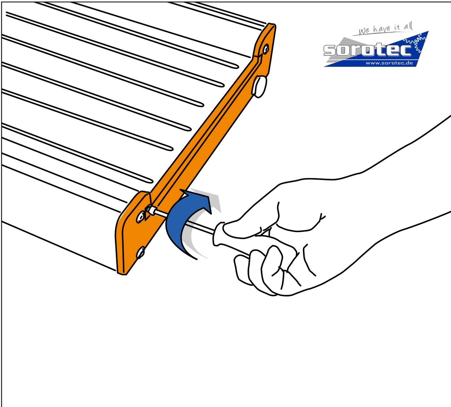
Verschraubung der Abdeckung wieder anziehen
