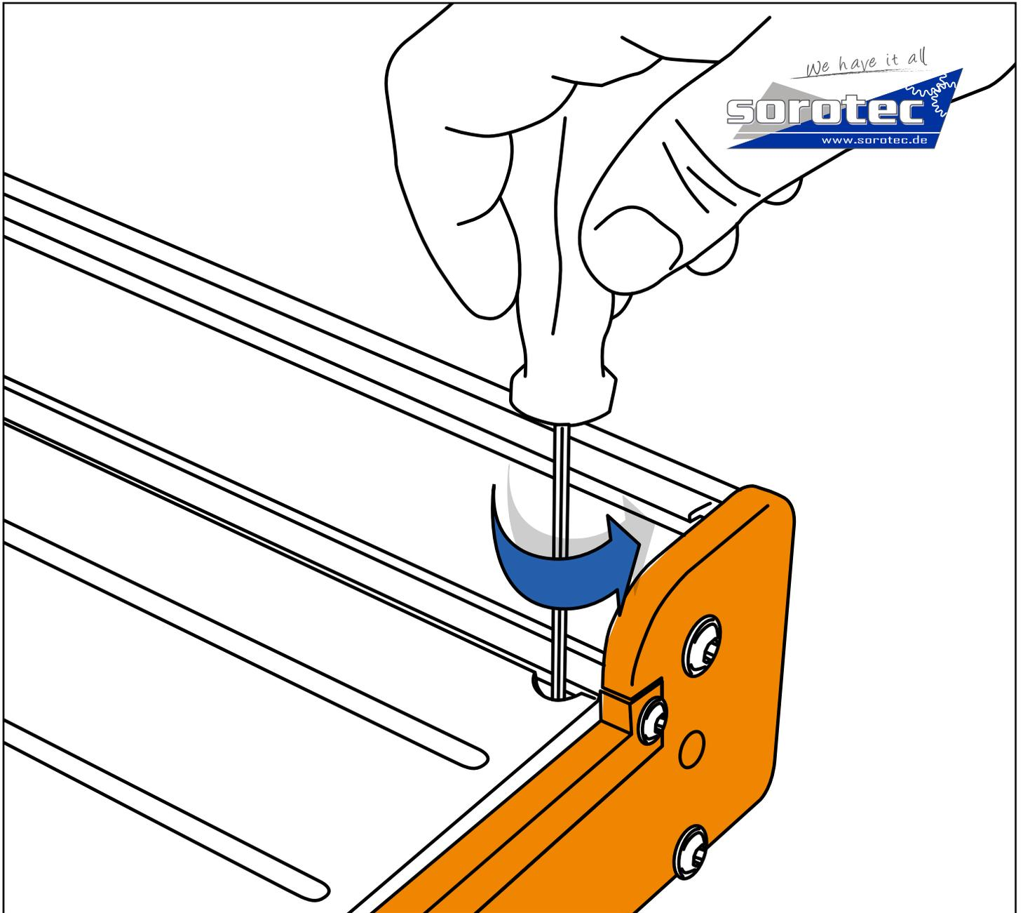
Fixierschrauben nach oben, gegen den Uhrzeigersinn (sic!) drehen bis die Nutenplatte sauber fixiert ist. Die Schrauben nicht zu fest anziehen!
